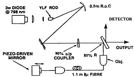
图 2 附加脉冲锁模 Nd:YLF 激光器结构
