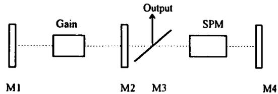
图 1 附加脉冲锁模原理图
